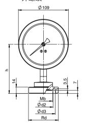
过程连接形式: 卫生型连接符合 DIN11851 管道标准: DIN11850 row 1 或 EN10357
